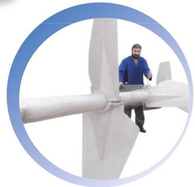
Les brassoirs verticaux GFL, qui sont actionnés par un motoréducteur à engrenages parallèles, fonctionnent avec de faibles vitesses de rotation et ils permettent d'utiliser des éléments agitateurs avec une grande surface de pale, de façon à obtenir un haut rendement de travail.
