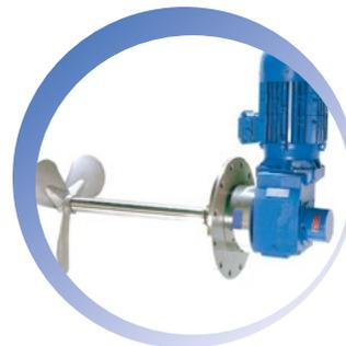
Les brassoirs latéraux LECOR et LMRE sont spécialement indiqués pour le maintien et le mélange de produits entreposés dans des cuves de moyen et grand volume. Ces équipements sont installés dans la partie inférieure du réservoir, avec un angle d'inclinaison et à une distance du fond qui dépendent de la forme et des dimensions du réservoir.
