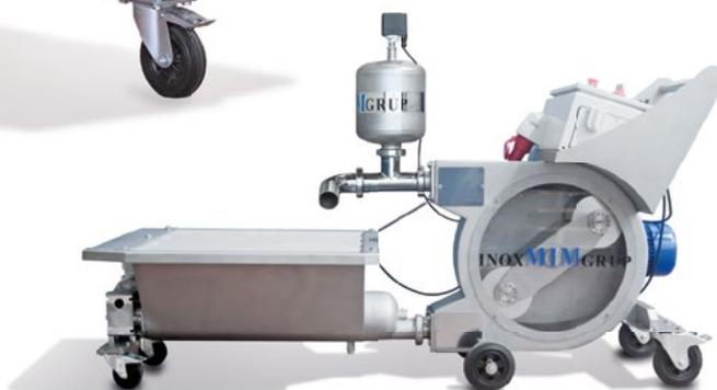
La pompe péristaltique permet de soutirer tout type de produit sans le maltraiter, puisqu'il n'y a pas de parties mécaniques en contact avec le fluide, qu'il s'agisse de produits à basse, à moyenne ou à haute viscosité.
